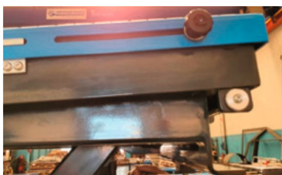
Réglage de l'inclinaison de la plateforme et pictogramme correspondant
